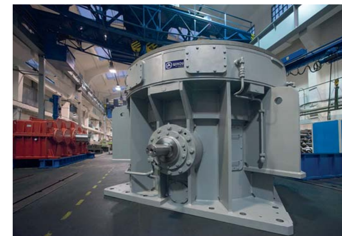
Převodovka vertikálního mlýna po repasi a upgradu
