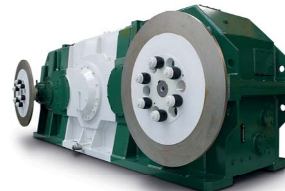
Čelní převodovka těžního stroje pro vertikální dopravu
